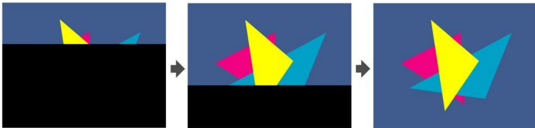
■ 図4.11——スキャンライン法の描画過程 (ポリゴンの配置は図4.6[a]と同じ。左から右の図へ描画が進行する)
